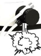
**Unterhalb des AIRFLOW®-Handstückschlauchsystems tritt Pulver aus**
